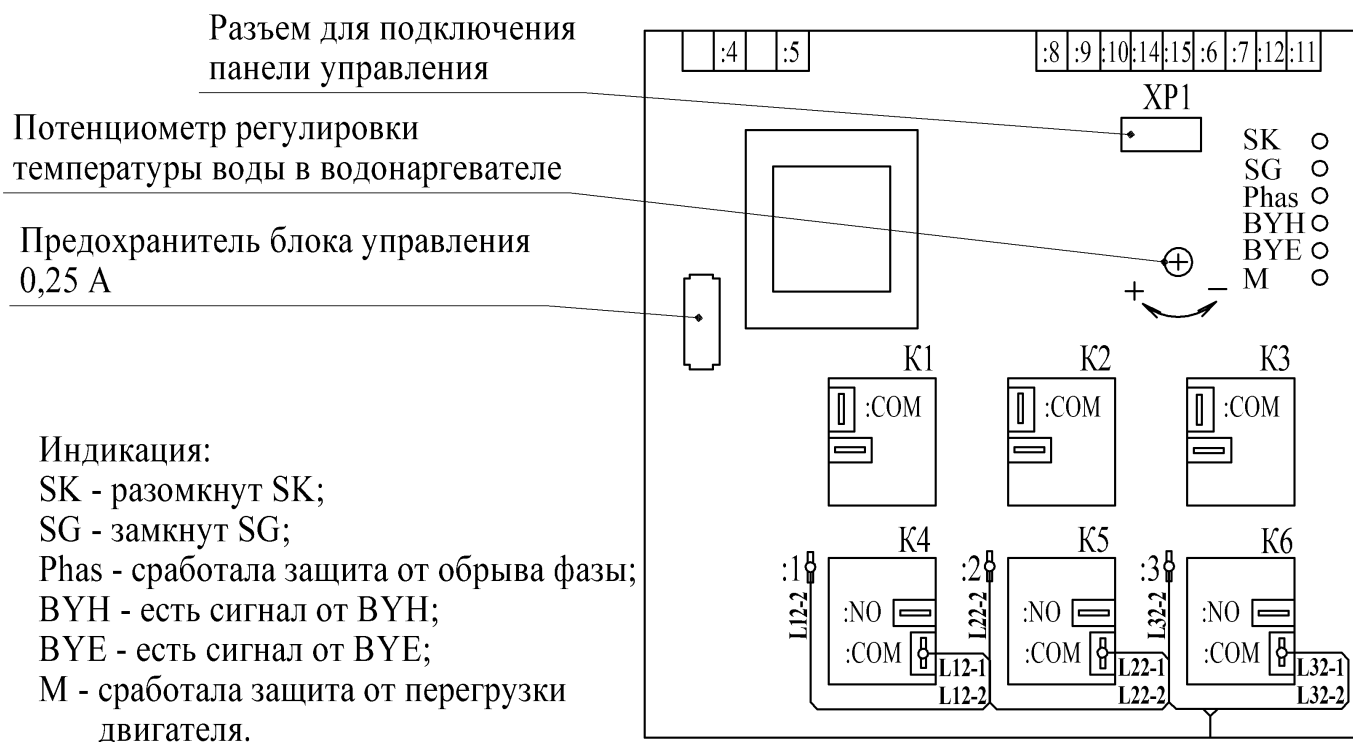
Рисунок 3 – Индикация цепей контроля и условное обозначение контактов блока управления
